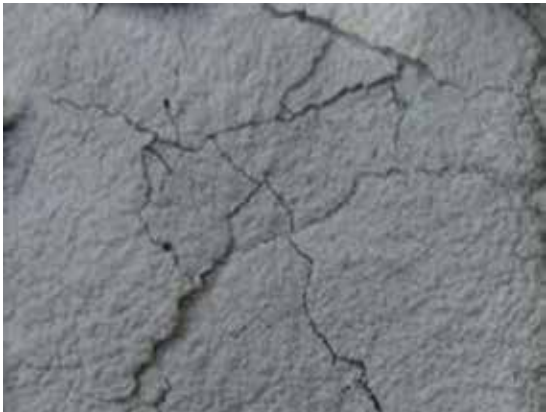
燃烧残留物：添加 +2% GENIOPLAST® Pellet S
